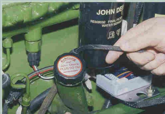
Ohne Löterei wird das Kabel des Zusatzsteuergerätes mit dem passenden Kombistecker ans Einspritzsystem angeschlossen (hier am Rail eines Common Rails.)
