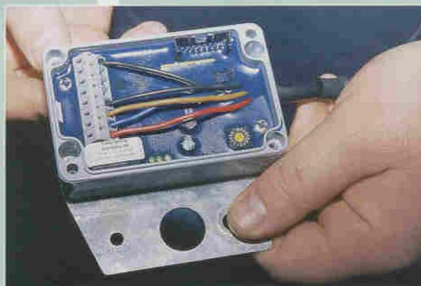
Das Innenleben der Zusatzsteuergeräte ist vergossen. Verstellen lässt sich nur der mehrstufige Drehschalter.
