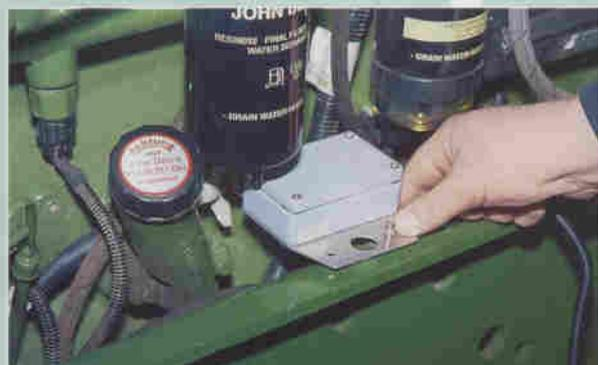
Das Zusatzsteuergerät wird mit Schrauben oder Kabelbindern befestigt.
